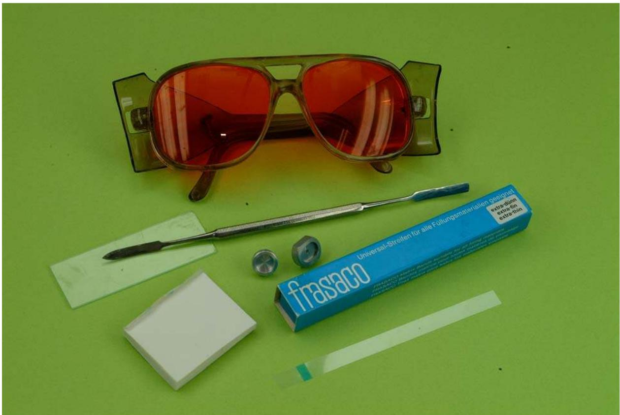
Abb. 3 Schutzbrille, Glasobjektträger, Probenhalter, Frasacostreifen
