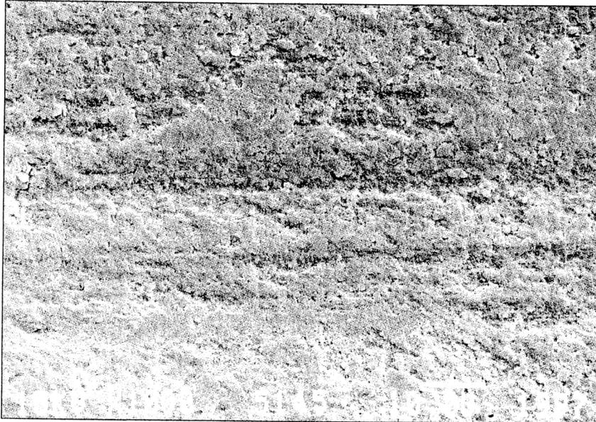
Abbildung 4.1: Oberfläche eines 1µm-Füller-Komposits nach 50 000 Zyklen (Gewichtsanteil: 53%)
