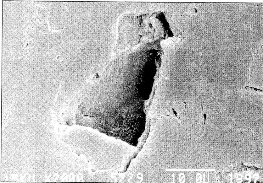
Abbildung 4.21: Herausgelöster Füllkörper, Komposit C21 (32% Gewichtsanteil Füllkörper), Vergrößerung 2000x
