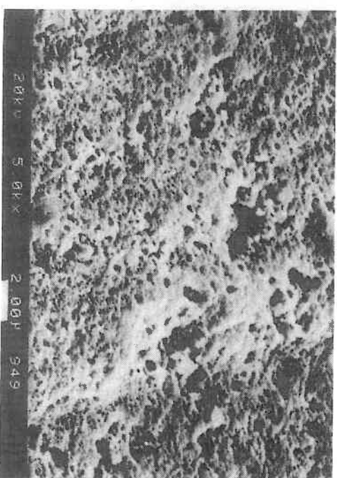
Abb. 18: REM-Aufnahme einer 3 Minuten geätzten TETRIC®-Probe, die Oberflächenstruktur ist verändert, sie weist flächige Defekte auf
