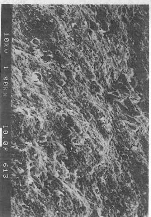
Abb. 8. REM-Aufnahme einer ungeätzten EMPRESS ® -Probe
