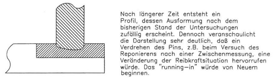
Abb. 1a Entstehung eines Abriebprofils beim Pin-on-disk-Versuch
