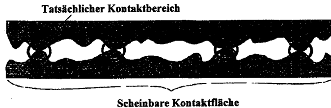
Abb. 2.5: Schematische Darstellung der scheinbaren Kontaktflächen und des tatsächlichen Kontaktbereichs (modifiziert nach K.H.z.Gahr [9]).
